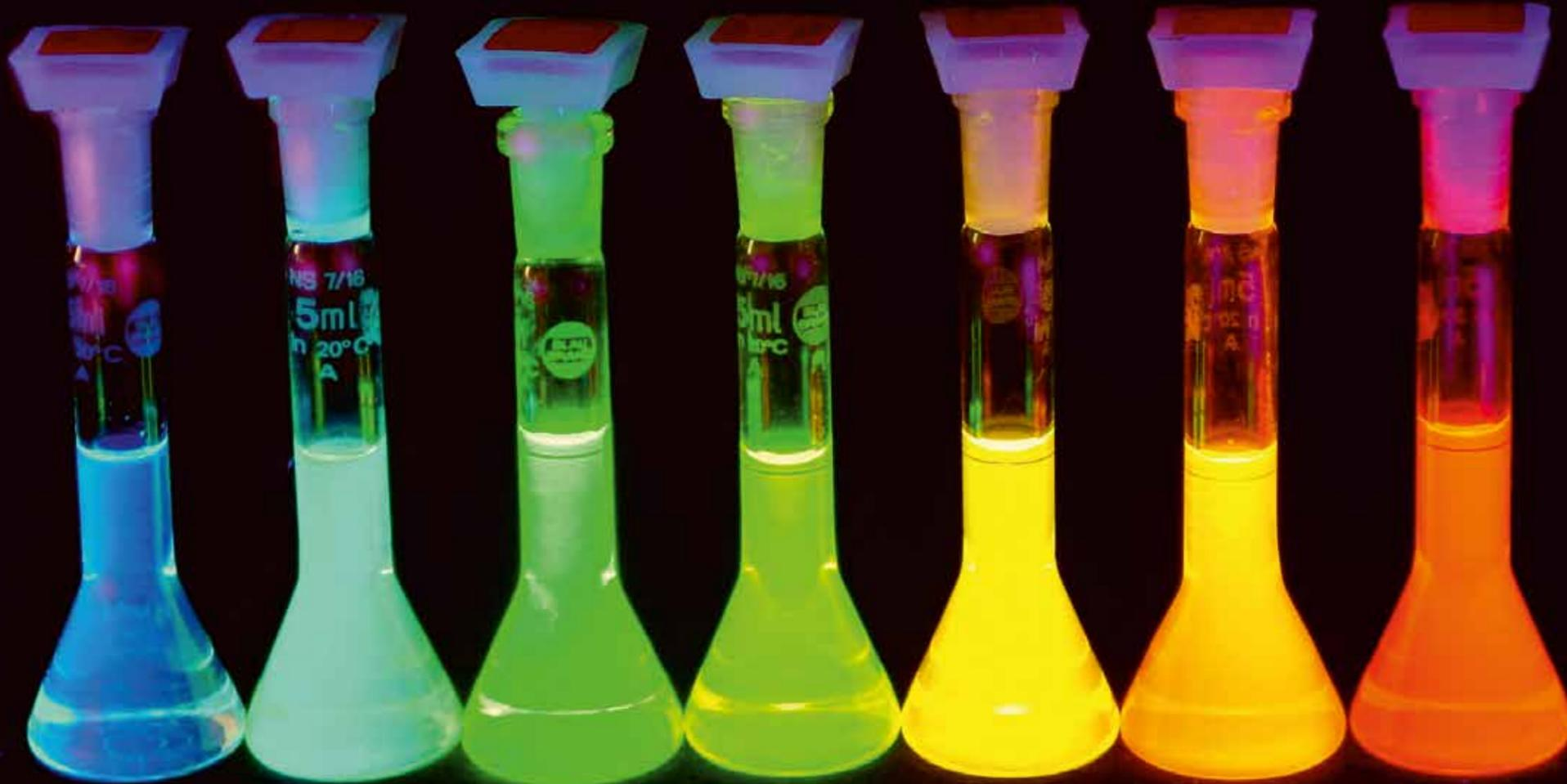
Bild: Die Lumineszenz von kolloidalen CdSe/ZnS-Nanopartikeln ist abhängig von der Partikelgröße (links: ~2nm, rechts: ~6nm) © 2024 Dmitri V. Talapin
